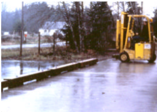
Los rieles de guía a la orilla de una zona de carga despejada reduce el riesgo de que las ruedas del montacargas se resbalen.
