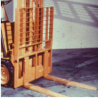
Una ampliación en el respaldo protege a de que la carga se resbale hacia atrás
