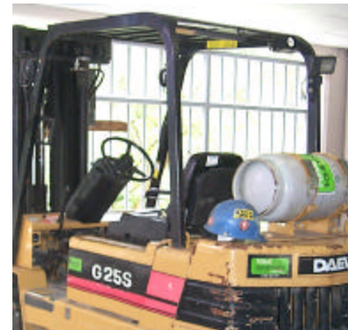
Una guarda de protección superior puede desviar objetos que caen desde arriba
