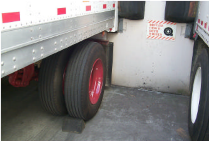
Coloque calzos en las ruedas traseras de los camiones o remolques para prevenir que se desplacen lejos de la plataforma de carga. Note como el rótulo le indica al conductor que atore bien las ruedas.
