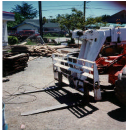
Ejemplo: Una manivela fue soldada al brazo de un vehículo tipo telescopio sin la autorización previa del fabricante.
